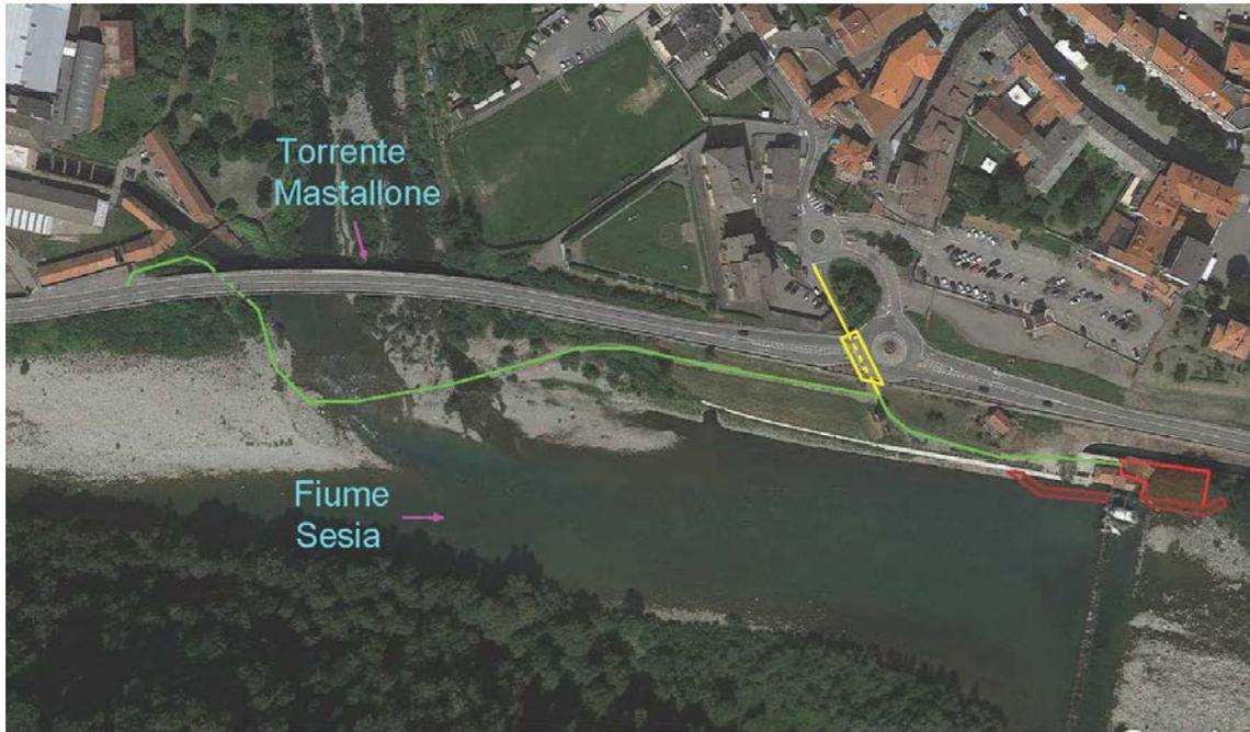
Figura 22: inquadramento dell'area oggetto dell'opera: in verde la pista di accesso transitabile dagli automezzi con altezze superiori a 3,40 m, in giallo la pista per l'accesso agli automezzi con altezze inferiori, in marrone le ture per la realizzazione delle opere
