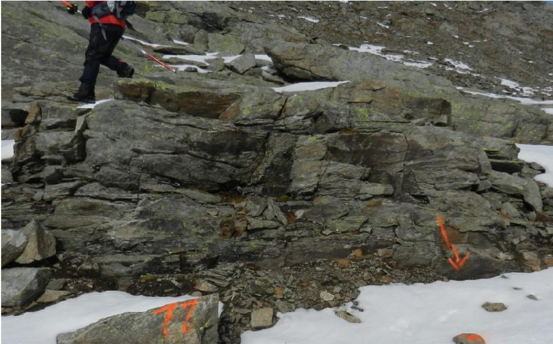
Lo studio geostrutturale è stato realizzato attraverso l'analisi delle principali caratteristiche fisiche dell'ammasso roccioso. Per la classificazione dell'ammasso roccioso è stato utilizzato il metodo di Bieniawsky basato sull'analisi quantitativa di parametri fisici, meccanici e strutturali.
