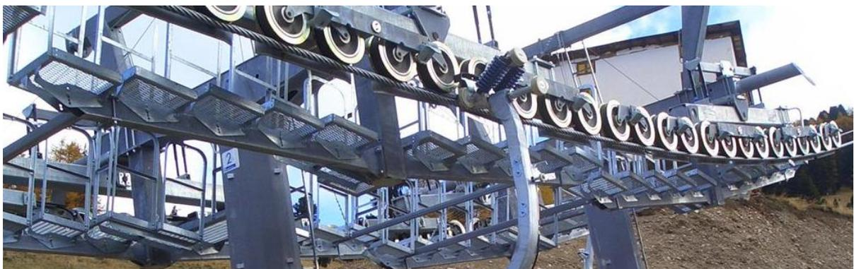
Internamente le stazioni sono dotate di percorsi di manutenzione in grigliato, per poter accedere ai meccanismi per la corretta esecuzione dei lavori di controllo e di ispezione.
