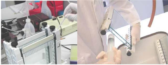
Figure 58 e 59: estrazione del pettine dallo stacking gel e lavaggio delle taschine.
