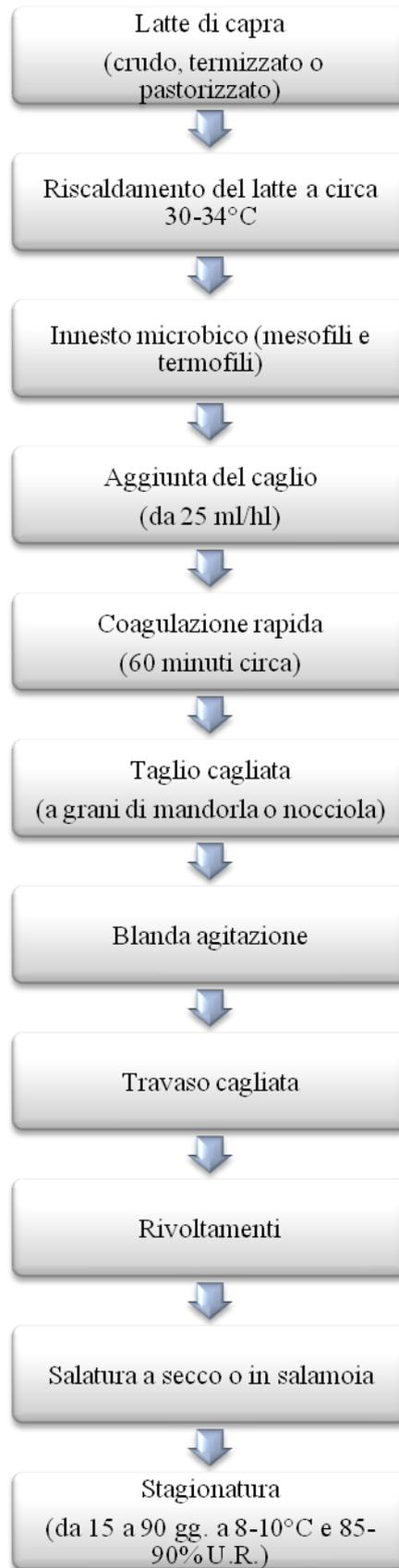
Figura 9: Processo di produzione del formaggio a coagulazione presamica.
