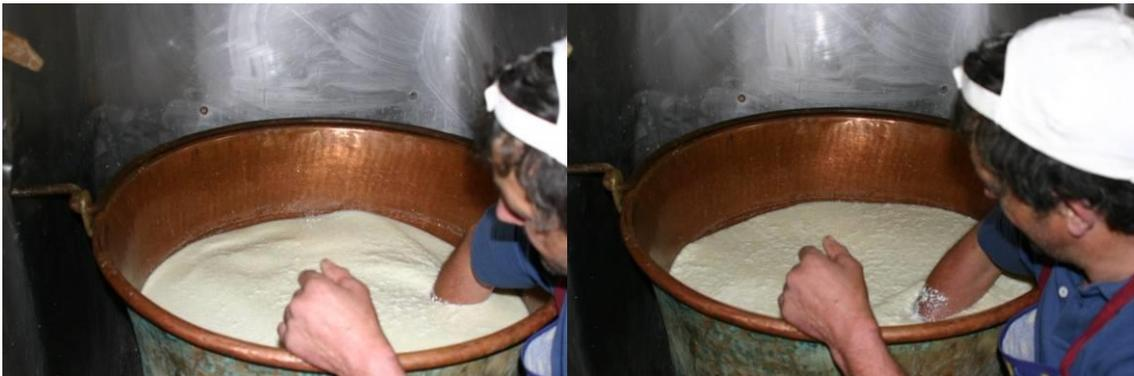
*Figura 23: Rottura manuale della cagliata.*
