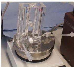
Figura 56: pompa per la realizzazione del gradiente di denaturazione del gel di poliacrilammide.
